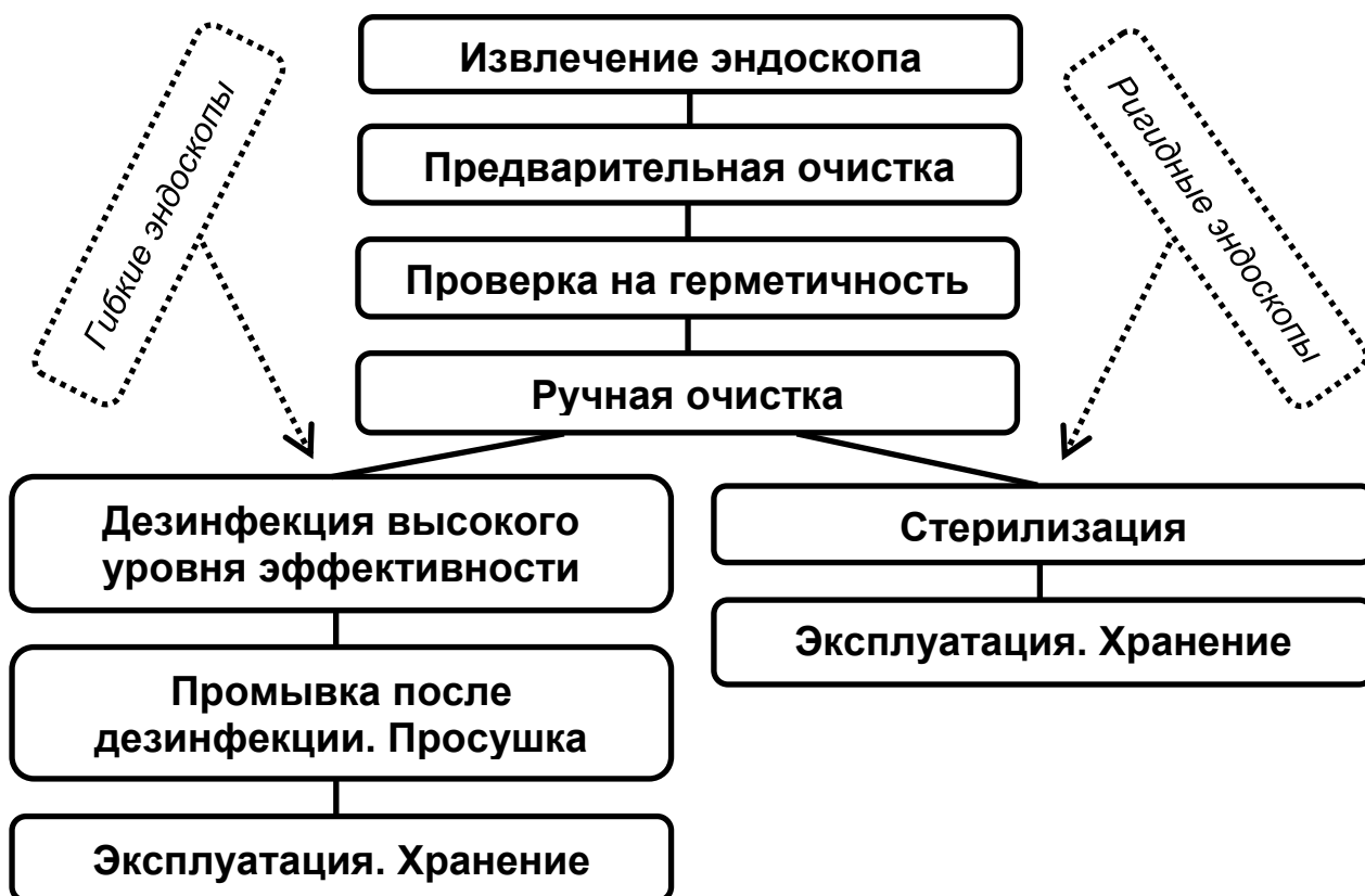
Рисунок 2. Схема процесса обработки эндоскопа.
